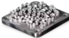
Fertigung von Teilkronen, Kronenkappen und Brücken aus LaserForm CoCr (C)
