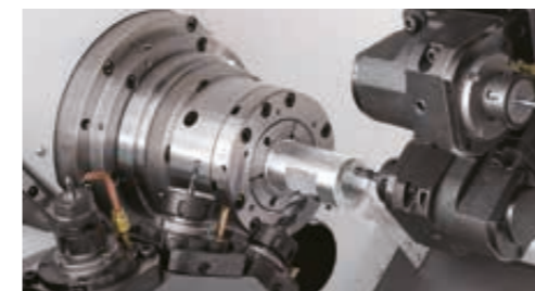
Simultane Bearbeitung komplexer Drehteile mit zwei Revolvern
